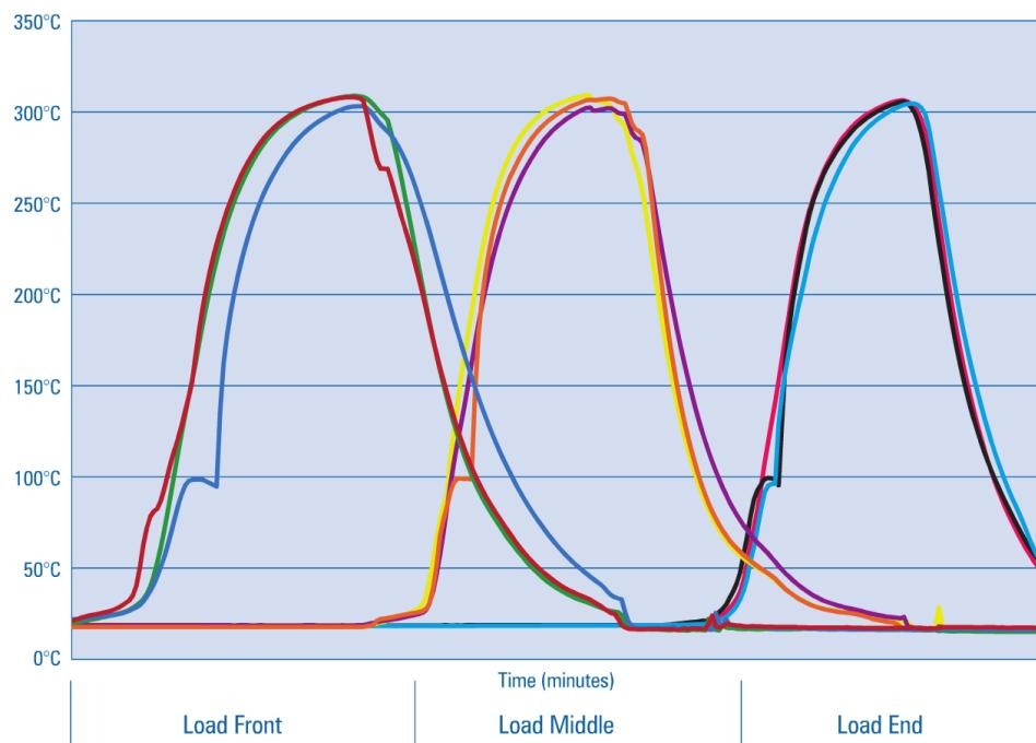
При этом может быть осуществлен подбор устанавливаемых параметров депирогенационного туннеля с целью оптимизации его работы и экономии ресурсов, поскольку варьирование установленной скоростью конвейерной ленты и/или температурой ТЭНов оказывает влияние на конечную эффективность процесса и производительность линии.
